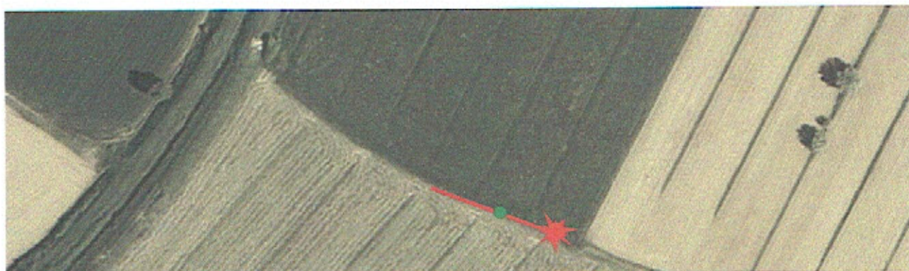
Fig.1. Profilo sismico (al centro dello stendimento -in verde- collocazione del velocimetro per l'indagine H.V.S.R.)
